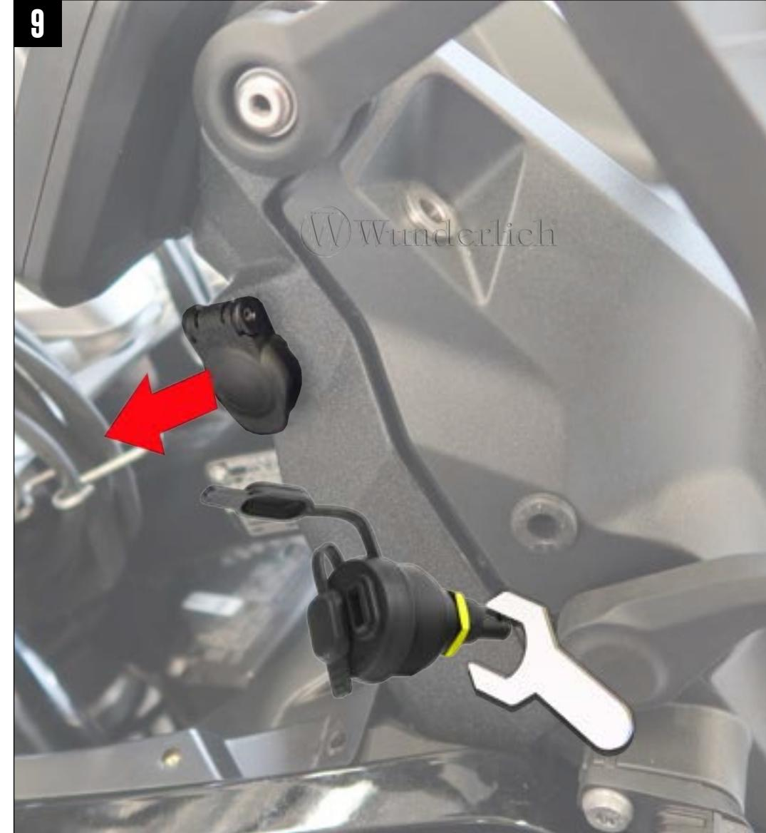
**BEI DER ELEKTRISCH VERSTELLBAREN WINDSCHILDVERSTELLUNG REICHT ES AUS DEN GRUNDHALTER ETWAS NACH VORNE ZU KIPPEN. DANACH DIE ORIGINALE BORD-STECKDOSE ABKLEMmen UND DIE USB-DOSE ANSCHLIEßen.**
