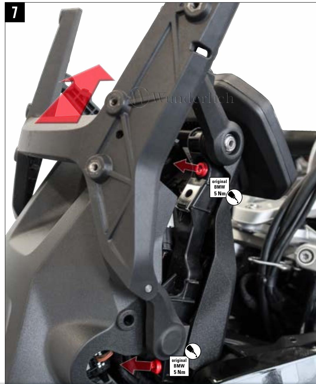
**ABDECKUNG DER WINDSCHILDVERSTELLUNG LÖSEN BZW. NAVI HALTER DEMON (BILD2). WINDSCHILDHALTER IN DIE OBERSTE POSITION BRINGEN UND DIE SCHRAUBEN DES GRUNDHALTER DEMONTIEREN (BILD3).**
