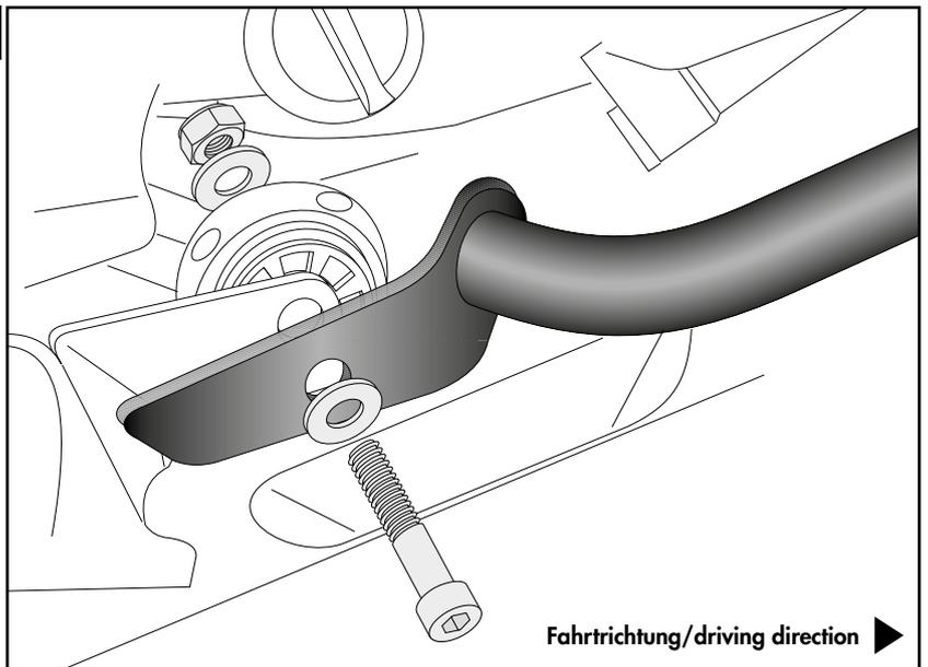
**Montage Motorschutzbügel vorne rechts:**
