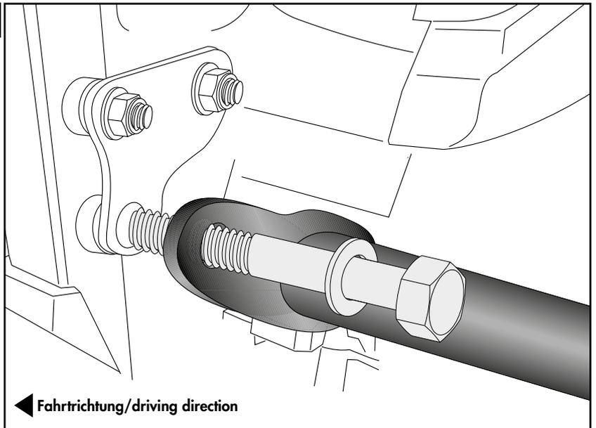
**Montage Motorschutzbügel hinten rechts:**
