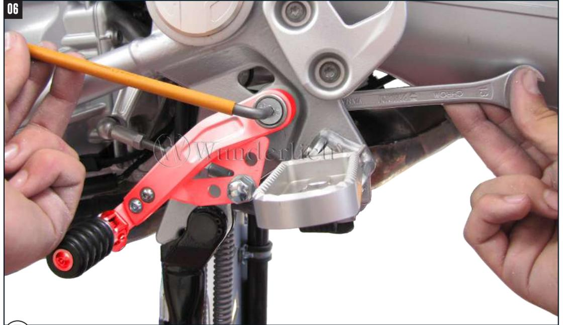
**!** Schalthebel über Schaltgestänge und Bohrungen +/- einstellen, alle Schrauben festziehen und einkleben!
